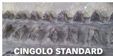
Dopo 180 ore di test gravoso, il cingolo standard si è rotto, mentre quello Camso ha continuato a funzionare per altre 20 ore. Ciò significa che il cingolo Camso a tecnologia Duradrive assicura almeno un 10% di durata in più.
